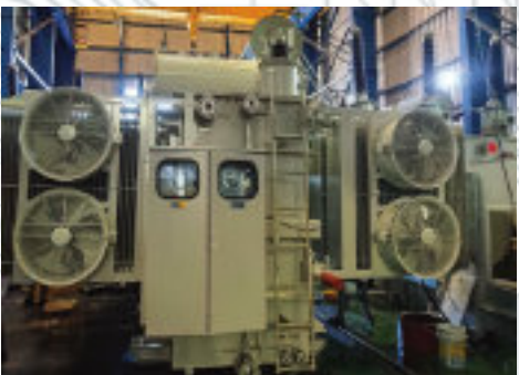
Transformador de relação unitária de 25/35 MVA, 13,8/13,8 kV, 60 Hz fornecido para o Texas, EUA
