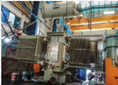
Transformador de interconexão de 12 MVA, 13,8/12,47 kV, 60 Hz fornecido para o Texas, EUA .
