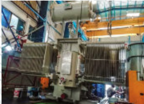
Transformador de interconexión de 12 MVA, 13,8/12,47 kV, 60 Hz suministrado a Texas, EE. UU.
